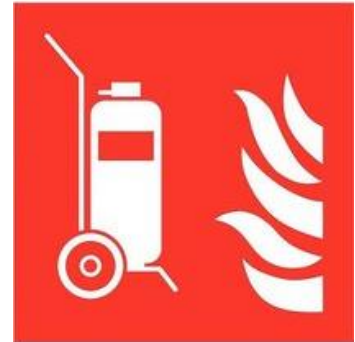
Extincteur sur roues
